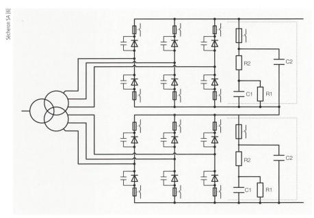
Figure 5 Redresseur à diodes 12 pulses.
