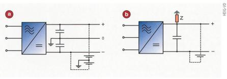
Figure 2 Câblage DC 3 fils (bipolaire) comparé à un câblage DC 2 fils (unipolaire).
