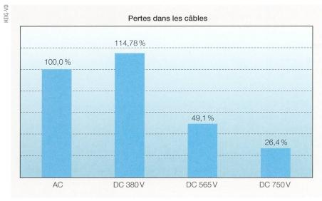
**Figure 7** Pertes dans les câbles simulées à différents niveaux de tension DC, exprimées relativement à celles du réseau triphasé classique.
