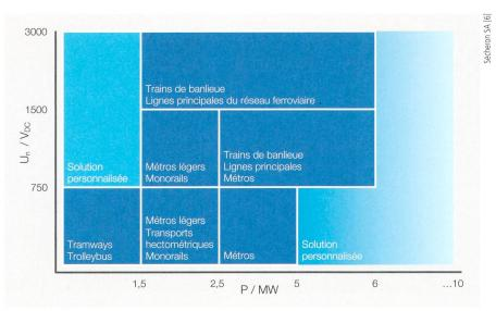
Figure 6 Gamme des produits existants pour différentes tensions DC et puissances.
