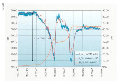
**Bild 5** Zuschaltung der 100-MW-Vollumrichterpumpe im Pumpspeicherkraftwerk Grimsel 2.
