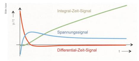
Bild 3 Differenzial-Zeit- und Integral-Zeit-Signal bei beispielhaftem Spannungsverlauf.
