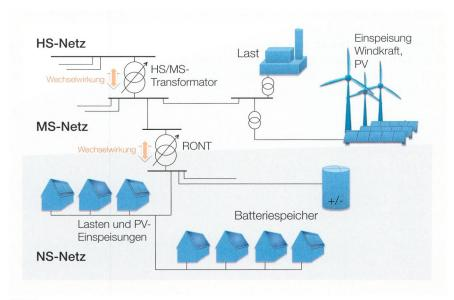
**Bild 2** Wechselwirkung verschiedener Netzebenen im Einflussbereich dezentraler Energieeinspeisungen.
