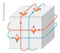
Stromfluss in einem topologischen Isolator. Der Strom fliesst nur an der Oberfläche und ist immer Spin-polarisiert.
