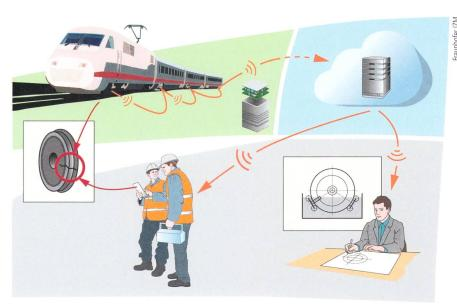
Cloud-gestütztes Sensornetzwerk zur zustandsbasierten Instandhaltung von Schienenfahrzeugen.
