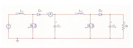
Figure 4 Hacheur élévateur de tension double boost en cascade.
