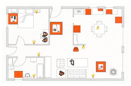
**Figure 1** Maquette de l'habitation considérée, d'une consommation de 2610 kWh/an avec une puissance maximale de  $4200 \text{ W}_c$ .
