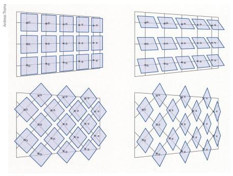
Bild 2 Designstudien der adaptiven Fassade mit verschiedenen Modulanordnungen.
