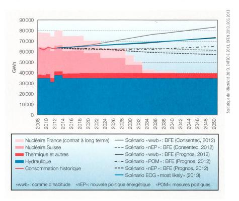
Figure 1 Evolution de la consommation et de la production annuelle d'électricité en Suisse.
