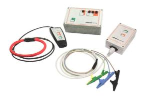
Das Kabelauslesegerät CI/CL von SebaKMT besticht durch seine einfache Bedienung. Es kann bei Niederspannungskabeln ohne Abschaltung der Netzspannung eingesetzt werden. Für die Auslese an freigeschalteten Kabeln dient ein Auslesegenerator der Impulse bis zu 100 A erzeugt. Das Gerät wird in einem Koffer als komplettes Set geliefert.
