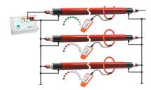
Identifizierung von Kabeln auch ohne Abschaltung der Netzspannung.
