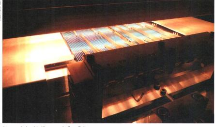
Automatisches Verlöten von halben Zellen.
