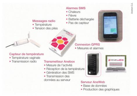
Figure 6 Vue synoptique du système Anemon.
