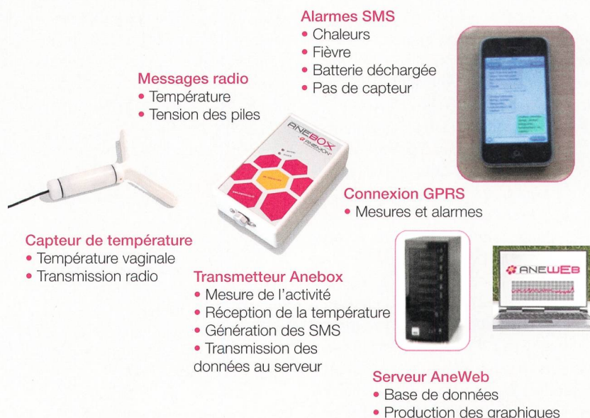
Figure 6 Vue synoptique du système Anemon.
