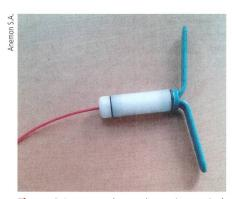
Figure 4 Le capteur de température intravaginal.
