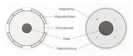
**Bild 7** 4-polige Läufervarianten, links mit NdFeB-Magnetschalen und rechts mit Ferrit-Compound.
