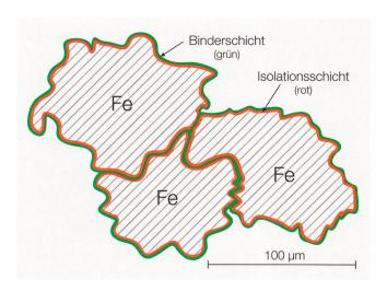
**Bild 1** Gefüge von SMC-Material.
