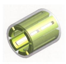
**Bild 5** Finale Montage des Ständers. Das SMC-Zahnelement mit geschrägtem Zahnkopf ist weiss dargestellt.
