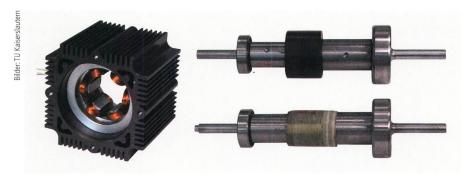
Bild 9 Komponenten des Funktionsmusters mit SMC-Blisterständer. Läufervariante R1 unten, R2 oben.
