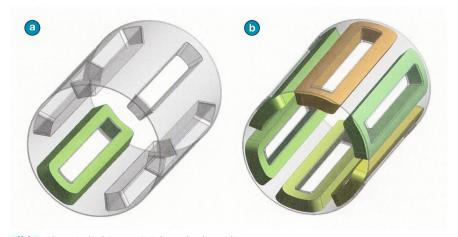
**Bild 3** Blister-Isolierkörper mit Zahnspulen bestückt.
