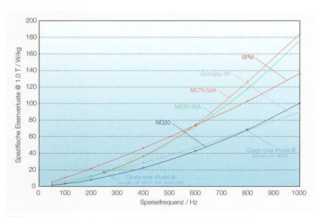
**Bild 2** Spezifische Eisenverluste von SMC-Material im Vergleich zu Elektroblech.
