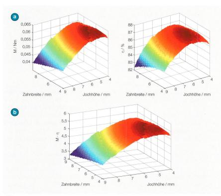
**Bild 8** Parameterstudie für den PM-Synchronmotor bei Bemessungszahl 20 000 min<sup>-1</sup>. Oben links: thermisch zulässiges Drehmoment, oben rechts: Wirkungsgrad, unten: Zielfunktion (Produkt aus Drehmoment und Wirkungsgrad).
