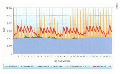
**Bild 3** Abbildung 3: Bild 1 ergänzt um Produktion aus Laufwasser (ohne Speicherüberlauf) und Windkraft.
