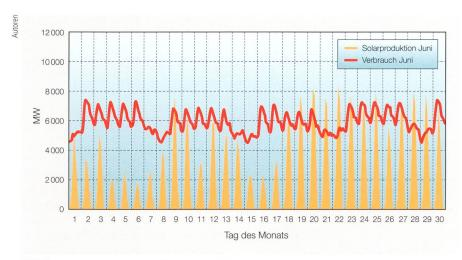
**Bild 2** Verbrauch Schweiz und Einspeisung PV (berechnet aufgrund der effektiven Sonneneinstrahlung), Juni 2008.
