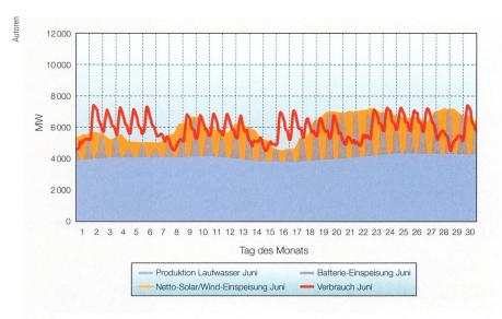
Bild 6 Auf eine Glättung der Lastspitzen im Netz optimierte Einspeisung (gepufferte Einspeisung).
