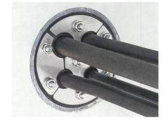
in die Wand einbetonierten Bauteil. Über ein Rahmensystem kann dieses Wandbauteil zusammengesteckt werden, so dass bei einer grösseren Anzahl von Kabeln eine einfache Paketbildung möglich ist. Zur Abdichtung der Kabel, die zu einem späteren Zeitpunkt verlegt und eingeführt werden, stehen je nach Kabelanzahl und Durchmesser unterschiedliche Systemdeckel zur Verfügung.
