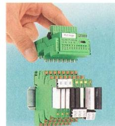
PLC logic: bestehend aus Logikmodulen, Relaisystem und Software.
