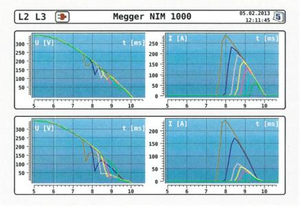
Bild 5 Fehlerfreie Verbindung (oben) und fehlerbehaftete Phase (unten).
