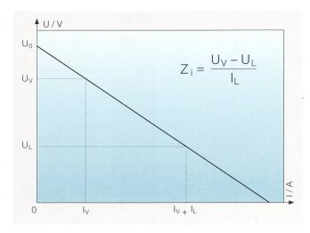
**Bild 2** Kennlinie einer idealen Spannungsquelle mit Innenwiderstand Z<sub>i</sub>.
