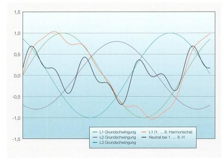
**Bild 1** Neutralleiterspannung (schwarz) bei oberschwingungsbehaftetem 3-Phasensystem mit Schieflast.
