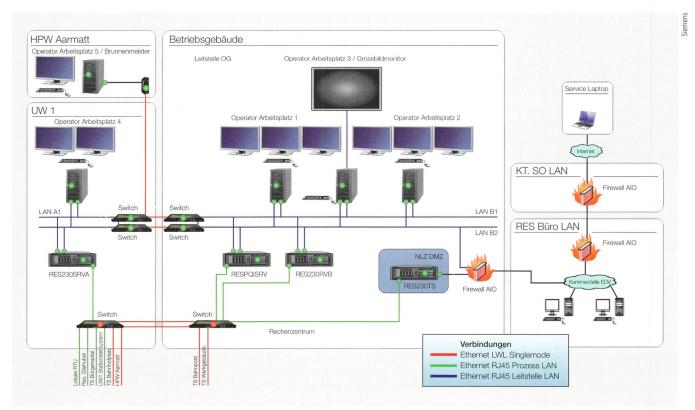
Je ein Server im Betriebsgebäude und im Unterwerk auf der anderen Seite der Aare überwachen die Gas-, Wasser-, Fernwärme- und Stromnetze redundant. Der Zugriff über das Internet ist durch mehrere Firewalls gesichert.
