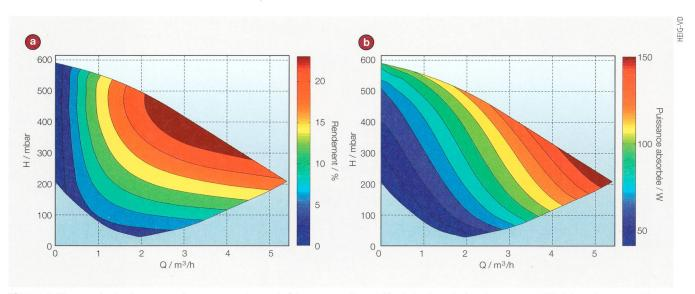
**Figure 4** Mesures du circulateur asynchrone avec variateur de fréquence sur l'ensemble de la plage de fonctionnement H(Q): (a) rendement et (b) puissance électrique absorbée.
