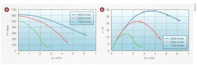
Figure 3 Mesures du circulateur asynchrone à commutation de bobinage : (a) caractéristique H(Q) et (b) rendement en fonction du débit.
