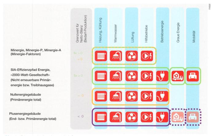
Bild 2 Klassifizierung Gebäude nach Energiebedarf.
