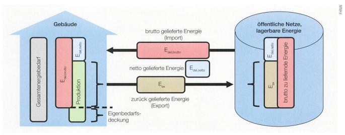
Bild 1 Energiebilanz eines Mustergebäudes mit Energieaustausch.
