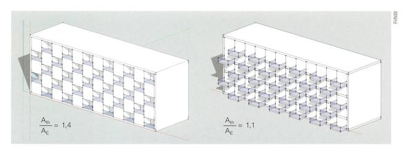
**Bild 3** Gebäudehüllzahl: Mehrfamilienhaus mit Balkonen, als Zusatzelement oder in den Bau integriert.
