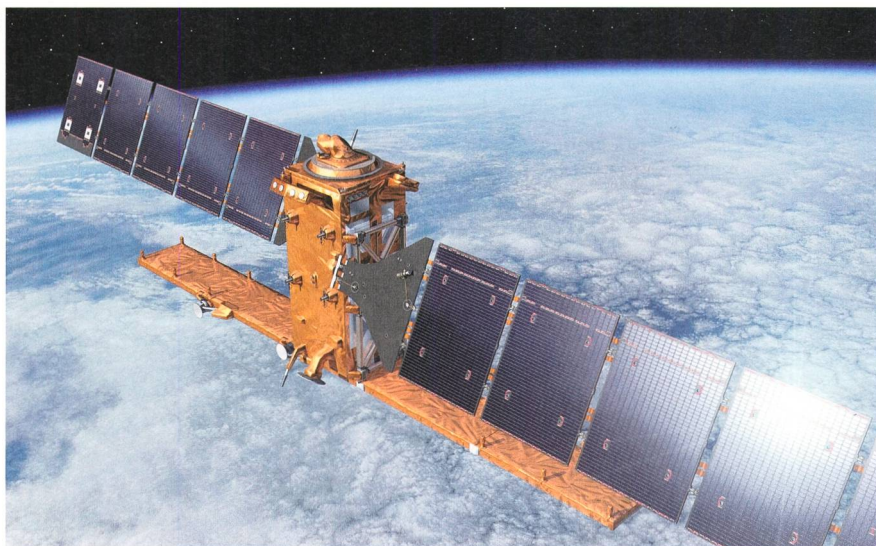
La structure circulaire du terminal de communication laser (LCT) doté de lasers pompés par diodes se trouve à l'extrémité supérieure du satellite Sentinel 1A.
