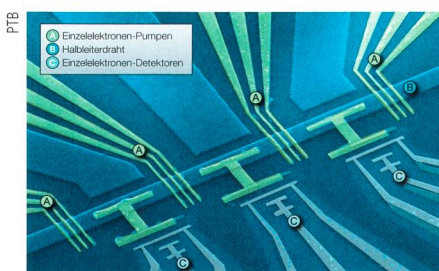
Halbleiterstruktur (vier Einzелеlektronen-Pumpen) zur Messung einzelner Elektronen und deren Ladung.
