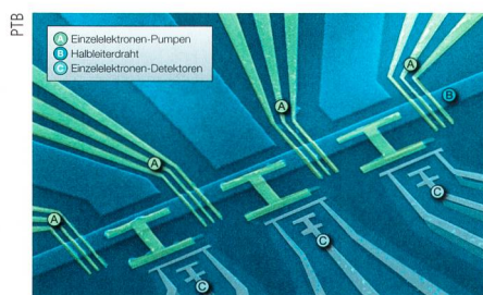
Halbleiterstruktur (vier Einzelelektronen-Pumpen) zur Messung einzelner Elektronen und deren Ladung.
