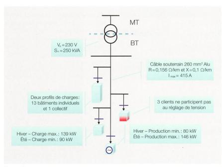
Figure 4 Aperçu du plan initial du réseau.
