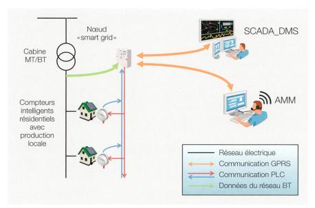
Figure 3 Architecture AMM au service du smart grid.
