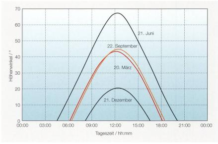
**Bild 5** Verlauf der Sonnenbahn für den Messstandort Campocologno ohne Horizontberücksichtigung; Zeitpunkte des Sonnenaufgangs und -untergangs für vier Termine des Jahres; Tageszeitangabe in Europäischer Winterzeit.
