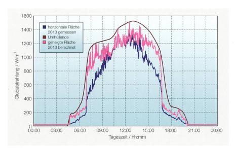
**Bild 3** Maximale Globalstrahlungswerte für jeden 2-Minuten-Termin im Tagesverlauf am Standort Campocologno. Maxima der Messwerte der Globalstrahlung auf die horizontale Fläche für das Jahr 2013 (blau); Maxima der täglich berechneten Werte für das Leiterseil mit Verlauf 145° (violett) sowie abgeschätzte Umhüllende (braun); Tageszeitangabe in Europäischer Winterzeit.
