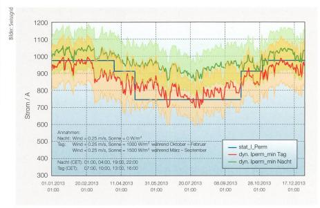
Bild 9 Vergleich statischer (blau) und dynamischer Grenzwerte Habsburgleitung (rot: Tag; grün Nacht).
