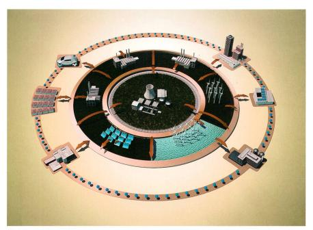
**Bild 3** Anstelle der klassischen Wertschöpfungskette der elektrischen Energie (oben) tritt zunehmend ein vernetztes, dezentralisiertes System (unten). Die Komplexität des Systems stellt im liberalisierten Markt nicht nur eine technische, sondern auch eine regulatorische Herausforderung dar.
