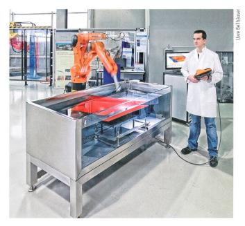
Un robot industriel relié au système de contrôle à ultrasons sonde une pièce.
