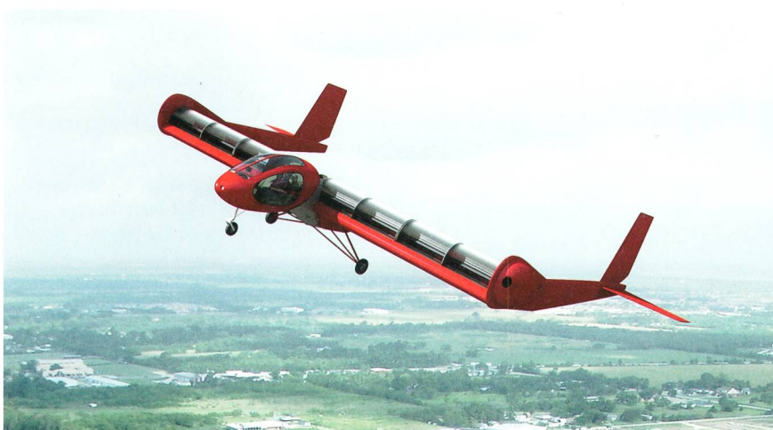
Das Flugzeug der Firma FanWing wird von breiten Rotorblättern in einer Walze über der Tragfläche angetrieben.
