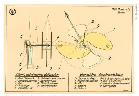
**Bild 4** Disposition eines elektrostatischen Voltmeters
