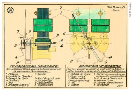
Bild 6 Aufbau eines ferrodynamischen Galvanometers.
