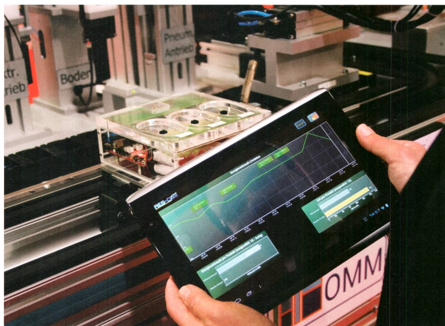
Anzeige des aktuellen Energieverbrauchs auf Tablet.
