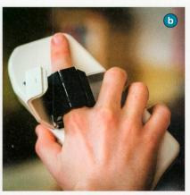
**Bild 3** Prototyp des neuen Comes All-in-One-Endgerätes, a) Vorderansicht mit Bedienfeld über Touchscreen, b) Rückansicht mit Sensor-Manchette.
