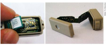
**Bild 8** Prototyp des Implantats zur Tumordiagnose und Therapie mit aussenliegendem planarem Sauerstoffsensor (in geöffnetem Zustand).
