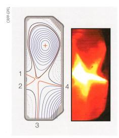
**Figure 10** Reconstruction de la section poloïdale (a) et photo (b) d'un plasma dit « snowflake » du fait de la structure hexagonale du point X.
