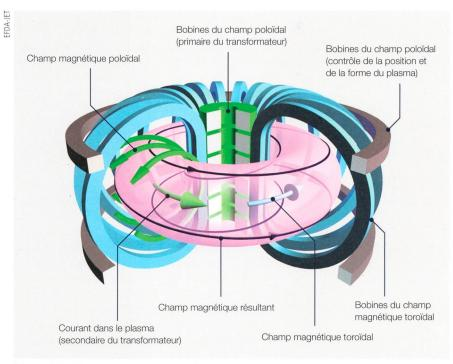
Figure 4 Schéma de principe du tokamak.
