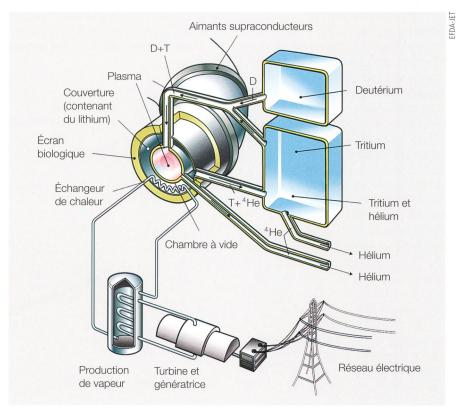
Figure 3 Schéma d'un réacteur à fusion.
