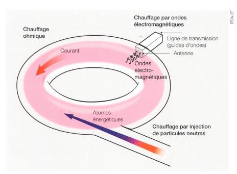
**Figure 5** Les différents types de chauffages du plasma: le chauffage ohmique, le chauffage par ondes électromagnétiques et le chauffage par injection de neutres.
