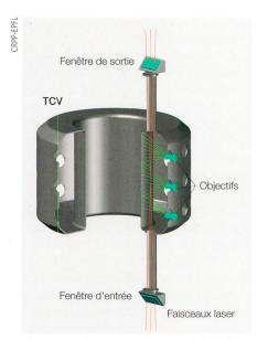
**Figure 8** Schéma d'implantation de la diffusion Thomson pour la mesure de la température du plasma.
