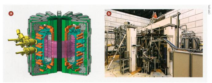
**Figure 9** Le tokamak TCV: schéma avec en cyan la chambre à vide où un plasma est représenté en violet, en vert les bobines du champ magnétique toroïdal, en orange les bobines du transformateur ohmique et les bobines de façonnage et en jaune les « lanceurs » du système de chauffage par microondes (a) et photo (b).
