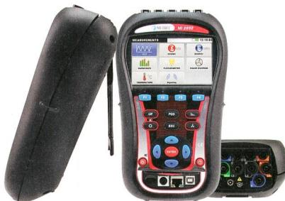
Analyse aller Daten und Langzeitaufzeichnungen sowie die automatische Erstellung eines Prüfberichts nach EN 50160. Die auf einer microSD-Speicherkarte aufgezeichneten Daten können über diverse Schnittstellen oder direkt von der MicroSD-Speicherkarte (bis 32 GB) ausgelesen werden. MI 2892 Power Master erfüllt folgende Standards: IEC/EN 61000-4-30, Kl. A, IEC/EN 61557-12, IEC/EN 61000-4-7, Kl. I, IEC/EN 61000-4-15; EN 50160, IEEE 1448, IEEE 1459.
