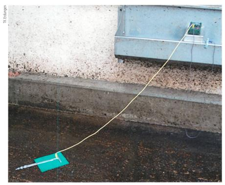
**Bild 2** Einfache Möglichkeit zur Kontaktierung eines Betonbodens mittels eines nassen Schwammlappens unter einer Metallelektrode zur Messung einer Wechselspannungsdifferenz zwischen dem Betonboden und einer metallischen Tränke.
