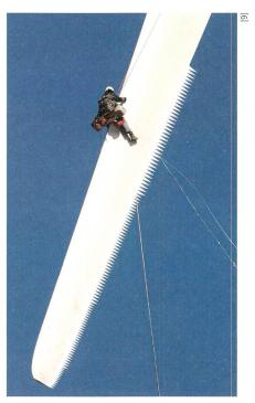
Figure 5 Dentelures en sortie de pale.
