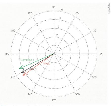
Bild 3 Vergleich Messverfahren für Stromwinkel.
