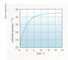
**Bild 4** Simulation des Leitertemperaturverlaufs in einem NS-Kabel. [3]
