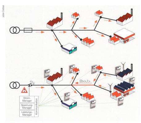
**Bild 2** Aktuelle und künftige Leistungsflüsse in Niederspannungsnetzen.
