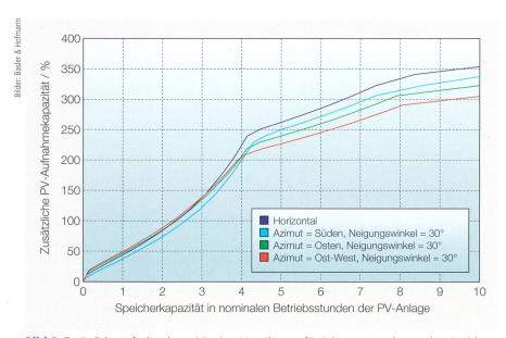
**Bild 6** Zusätzliche Aufnahmekapazität eines Verteilnetzes für Solarstrom vs. dezentralem Speicher.
