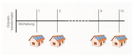
Bild 1 Für die Simulationen verwendete Stichleitung.
