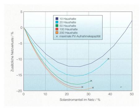
**Bild 3** Reduktion der Netzverluste mit dezentraler Erzeugung. «x» ist die maximal zulässige Einspeisung unter Berücksichtigung der Gleichzeitigkeit von Lasten und PV.
