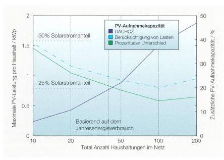
**Bild 2** Maximale Fotovoltaikleistung pro Haushalt gemäss DACHCZ-Regeln sowie unter Berücksichtigung der Lasten.
