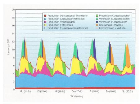
**Bild 2** Verlauf einer typischen Sommerwoche bei 100 % erneuerbarer Energie.
