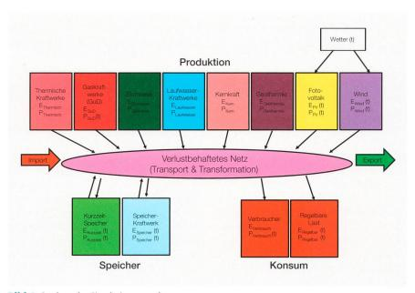
**Bild 1** Struktur der Simulationsumgebung
