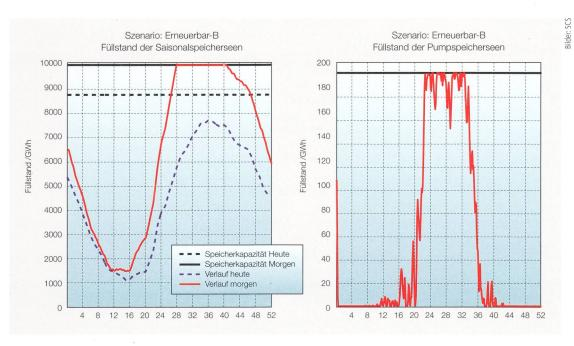
**Bild 5** Typischer Jahresverlauf des Füllstands der Speicherseen bei 100 % erneuerbar (autarker Betrieb).
