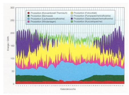
Bild 4 Typischer Jahresverlauf bei 100 % erneuerbarer Energie.
