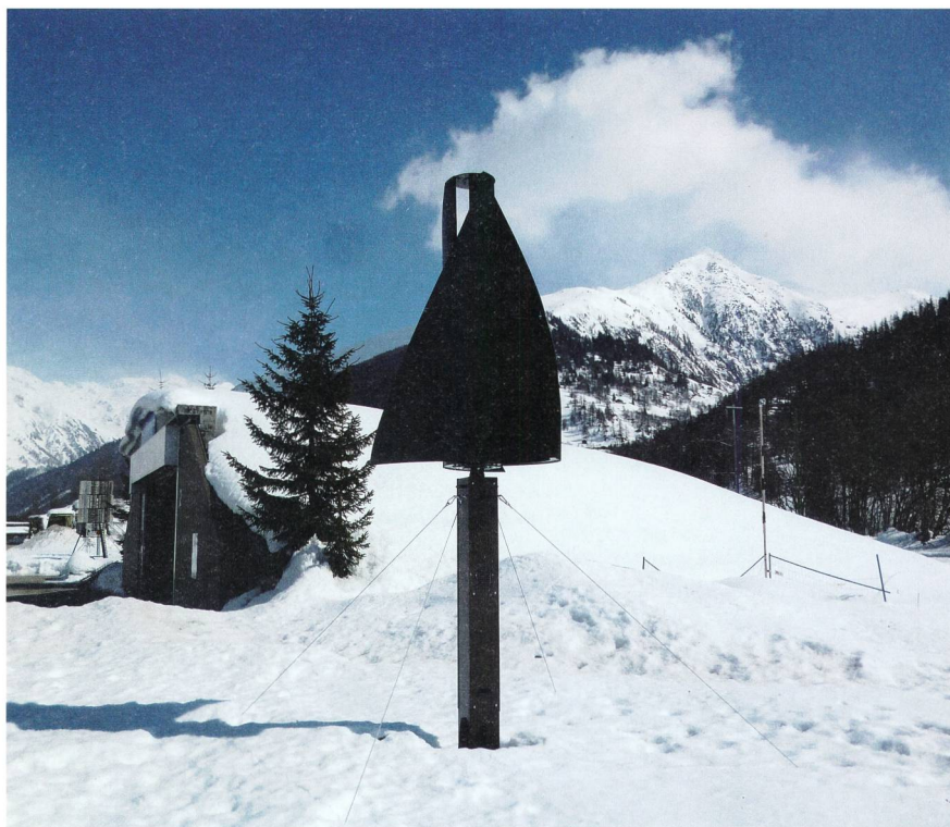
Bild 3 Die Wind-Tanne lag im Wettbewerb «Aufwind» punkto Energie-Ernte im Mittelfeld. Ihre Vorteile liegen bei der Stabilität, und sie ist einem wichtigen Oberwalliser Landschaftselement nachempfunden.
