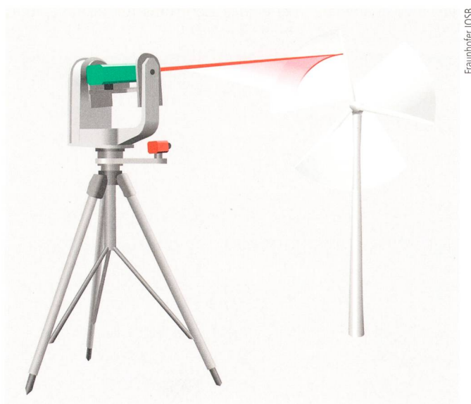
Der Laser folgt dem Rotorblatt und bleibt exakt auf derselben Position auf dessen Oberfläche. Betreiber von Windkraftanlagen können so das Schwingungsmuster der Bauteile messen.
