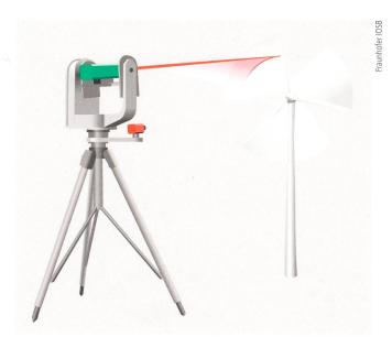
Der Laser folgt dem Rotorblatt und bleibt exakt auf derselben Position auf dessen Oberfläche. Betreiber von Windkraftanlagen können so das Schwingungsmuster der Bauteile messen.
