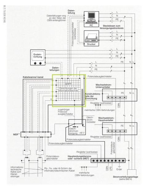
**Bild 2** Prinzipbeispiel einer verbesserten Potenzialausgleichsanlage in einem Gebäude. [1] In Bereichen mit einer Massierung von IT-Einrichtungen, wie sie in Serverräumen oder Rechenzentren vorkommen, ist die Installation einer SRPP-Struktur die optimale Lösung.
