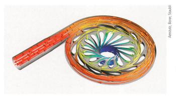
**Bild 2** Simulationsdomäne der Francisturbine mit Stromlinien.
