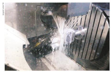
Figure 4 Usinage d'un auget.
