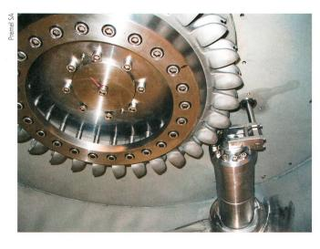
Figure 7 Roue de la turbine Pelton sur l'eau potable de la commune de Haut Intyamon/FR (débit: 40 l/s, chute: 502 m, puissance électrique: 160 kW, mise en service en 2007).
