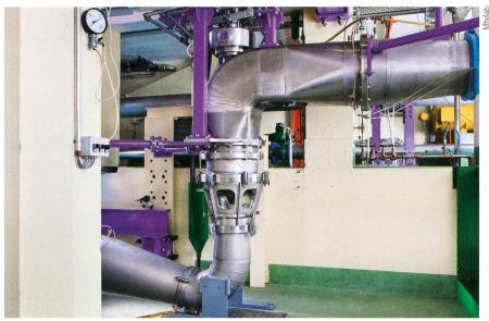
Figure 3 Turbine Diagonale sur stand d'essais.
