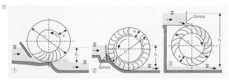
**Bild 2** Haupttypen von Wasserrädern: 1) unterschlächtiges Schaufelrad; 2) mittelschlächtiges Zellenrad; 3) oberschlächtiges Zellenrad.
