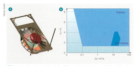
**Bild 7** VLH-Turbine: a) Prinzipskizze [13] und b) Haupteinsatzbereich im Vergleich zu Turbinen, bezogen auf Fallhöhe und Durchfluss.
