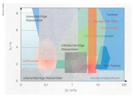
**Bild 10** Zusammenfassende Darstellung der Haupteinsatzbereiche unterschiedlicher hydraulischer Strömungsmaschinen im Vergleich zu Turbinen bezogen auf die Fallhöhe und den Durchfluss (die Grenzen sind fliessend).
