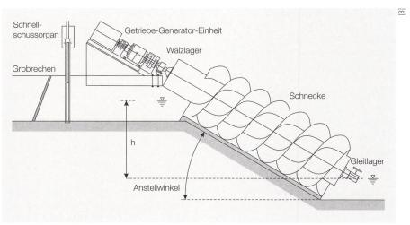
**Bild 4** Prinzipieller Aufbau einer Wasserkraftschnecke.
