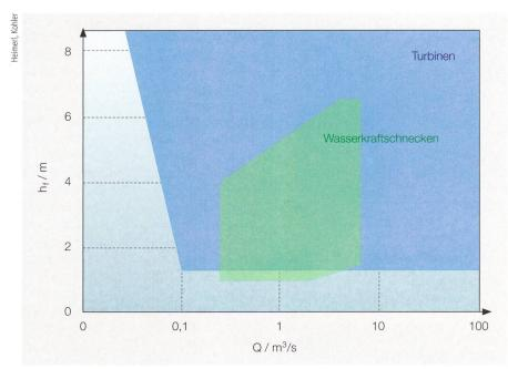
**Bild 3** Haupteinsatzbereich für Wasserkraftschnecken im Vergleich zu Turbinen, bezogen auf die Fallhöhe und den Durchfluss.
