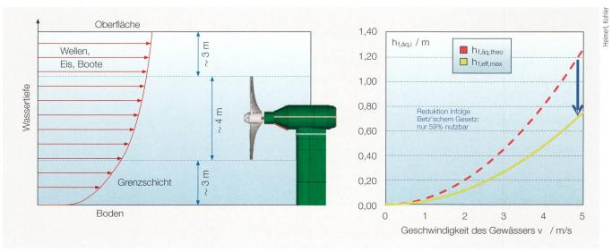
**Bild 9** Kinetische Strömungsmaschinen: Qualitative Strömungsgeschwindigkeitsverteilung über die Wassertiefe am Beispiel eines 10 m tiefen Fliessgewässers (links) [16]; Äquivalente Fallhöhen h<sub>f,āq,theo</sub> der vorhandenen kinetischen Energie und h<sub>f,eff,max</sub> der durch frei umströmte Strömungsmaschinen nutzbaren kinetischen Energie (rechts).
