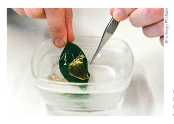
Die hauchdünne Elektronikmembran haftet auf verschiedenen Oberflächen.
