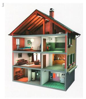
Bild 1 Das virtuelle Asbesthaus zeigt, in welchen Bereichen Gefahren drohen.
