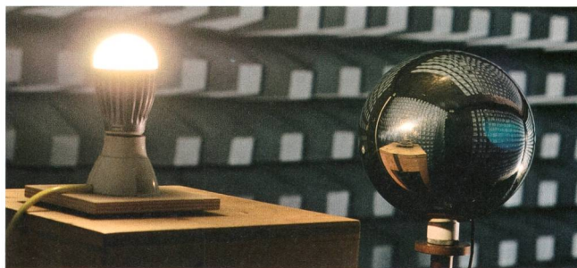
Bild 8 Messung der elektromagn. Felder einer Retrofit-LED.
