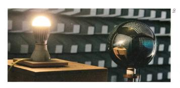
**Bild 8** Messung der elektromagn. Felder einer Retrofit-LED.
