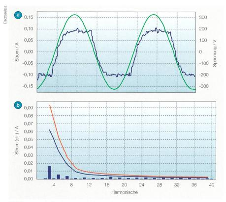
Bild 9 Stromverlauf und Harmonische bei Acrich2.
