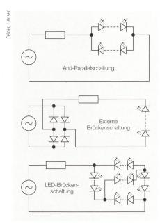
**Bild 2** Typologien der verschiedenen AC-LED-Schaltungen.
