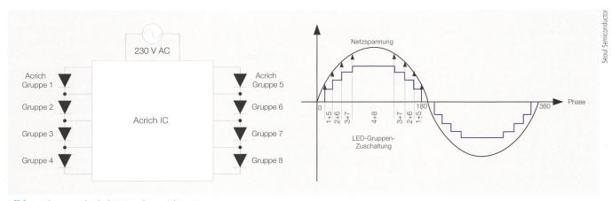
**Bild 4** Schema und Schalttiming der Acrich2-LED.
