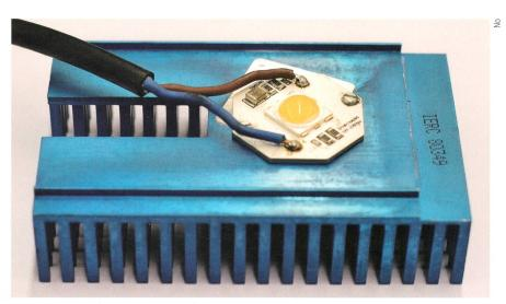
**Bild 1** Eine AC-LED von Samsung auf Kühlkörper (Laboraufbau).
