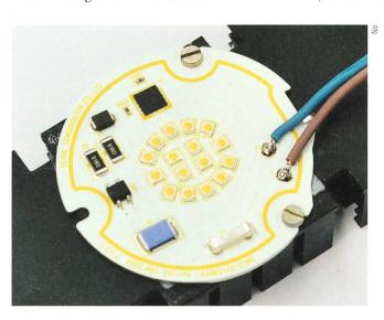
**Bild 3** Acrich2 AC-LED (Laboraufbau).
