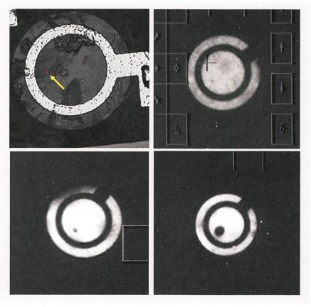
**Bild 4** Oben links: LED in Sperrrichtung; mit einem Emissionsmikroskop wurde bei 1  $\mu$ A eine Störstelle genau gegenüber der von rechts oben ankommenden Metallisierung (hell) geortet (blauer Punkt, Pfeil). Im Bereich der Störstelle ist zunächst ein winziger dunkler Schatten erkennbar, der sich im Betrieb allmählich vergrössert (unten) und so die abgestrahlte Lichtleistung verringert.
