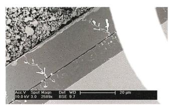
**Bild 2** Dendriten-wachstum aus einem Silberleitkleber an einer Chipkante. Solche Dendriten treten häufig auch zwischen einzelnen Leiterbahnen innerhalb des LED-Gehäuses auf.
