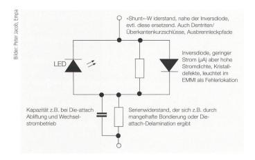
**Bild 5** Ersatzschaltbild einer LED mit Fehlerstrompfaden.
