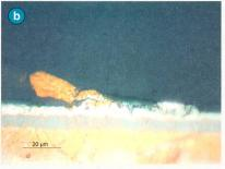
**Bild 1** a) Übersicht der Bondierung, rechts endet der Bonddraht auf dem Pin in Form eines Stitchbonds; b) Detailbild der geschädigten Stitchbondierung.
