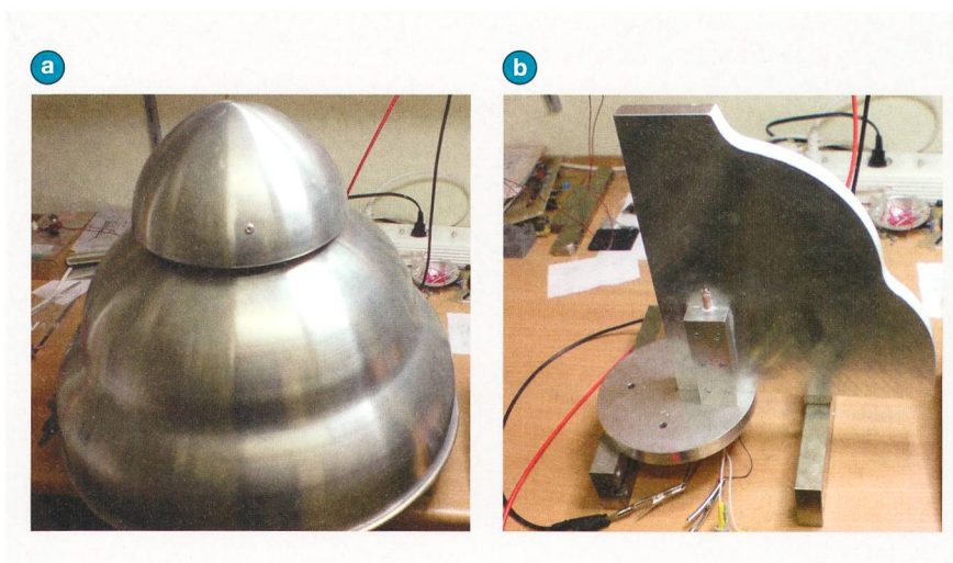
Bild 5 a) Originalhaube und b) einer der 4 Entwärmungsflügel.
