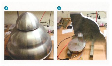
**Bild 5** a) Originalhaube und b) einer der 4 Entwärmungsflügel.
