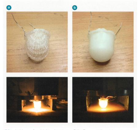
**Bild 9** a) Glühstrumpf aus lichtleitendem Musterstoff, b) Diffusor aus Vollmaterial. Aus 4 m Distanz lässt sich kein Unterschied zwischen einem Original-Glühstrumpf und dem Kunststoff-Imitat ausmachen.
