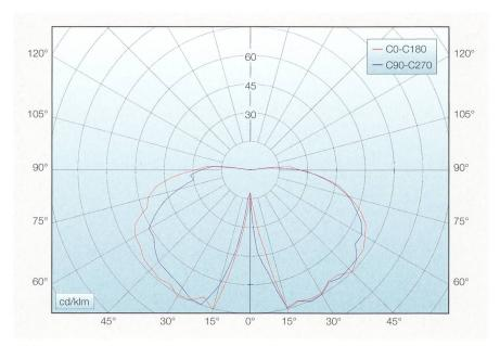
Bild 4 Lichtstärkeverteilungskörper (LVK) einer Gasaufsatzleuchte in 2 Achsen radial gemessen.
