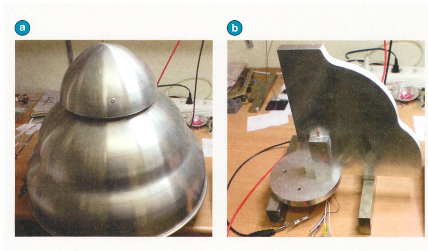
Bild 5 a) Originalhaube und b) einer der 4 Entwärmungsflügel.
