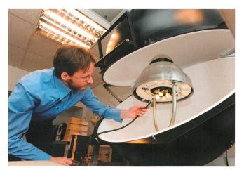
**Bild 1** Testleuchte in Ulbrichtkugel.
