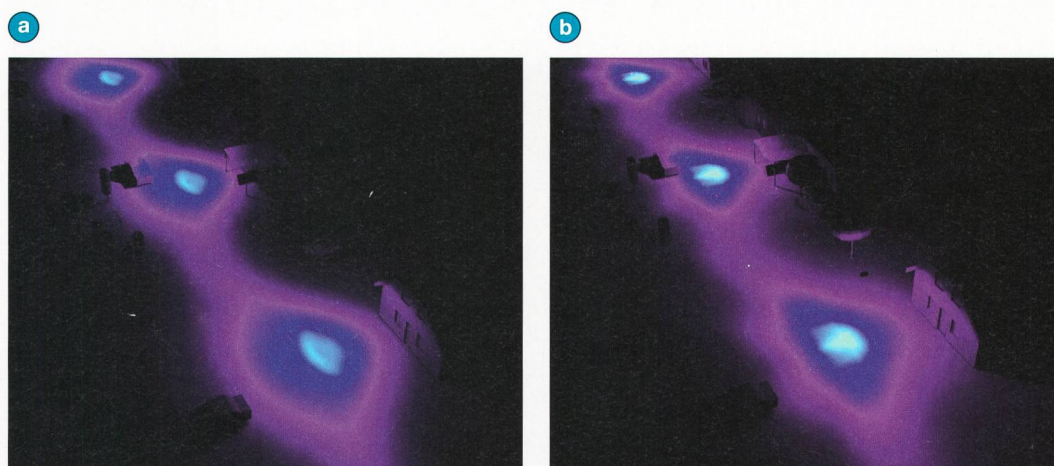
Bild 2 Lichtverteilung von a) LED (37 W pro Leuchte) und b) Natriumdampf (60 W pro Leuchte) bei einer Quartierstrasse.
