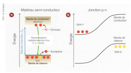
**Figure 2** (a) Diagramme d'énergie d'un semi-conducteur et (b) structure de bande d'une jonction p-n à l'équilibre.
