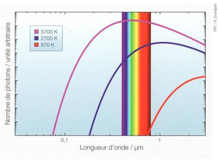
**Figure 1** Spectre d'émission du corps noir pour différentes températures : soleil (5700 K), lampe à incandescence (2700 K) et 600 °C (870 K), ce qui correspond au début de l'émission dans le visible.
