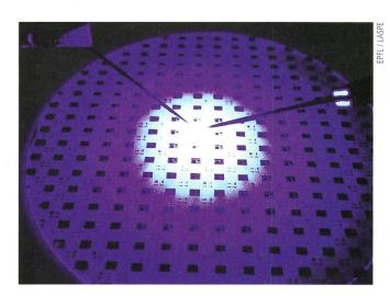
**Figure 6** Électroluminescence d'une LED GaN sur substrat de saphir.
