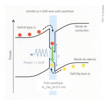
**Figure 4** Structure de bande d'une LED bleue à puits quantique polarisée en direct (V > 0).
