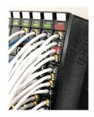
LEDs am Kanal und am Modul für eindeutige Zuordnung und Diagnose.
