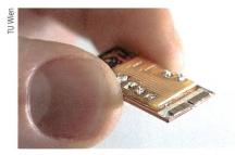
Ein einsatzbereiter Terahertz-Quantenkaskadenlaser.
