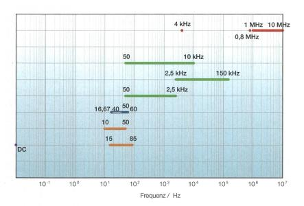
**Bild 5** Frequenzanteile von Spannungs- und Stromsignalen im Hochspannungsnetz.
