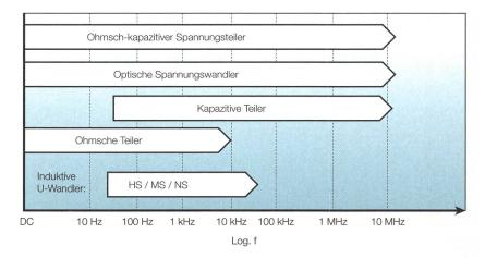
Bild 6 Frequenzgang verschiedener Messmethoden der Spannungsmessung nach IEC/TR 61869. [4]
