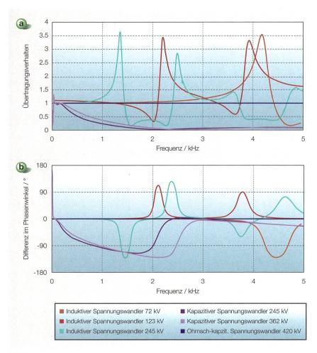
Bild 7 Übertragungsverhalten verschiedener Spannungswandlertypen.
