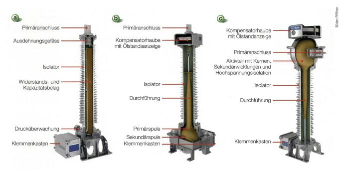
Bild 8 Aufbau moderner Hochspannungswandler (v.l.n.r. Ohmsch-kapazitiver Teiler, Induktiver Spannungswandler, Induktiver Stromwandler).
