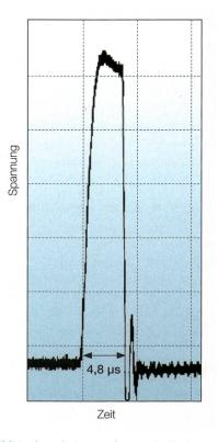
**Bild 4** Abgeschnittener Blitzstoss in SF<sub>6</sub>-Atmosphäre.
